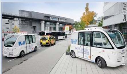
und einer Breite von 2,11 Metern ist der Kleinbus nicht viel größer als ein durchschnittlicher Transporter, überragt aber mit einer Höhe von 2,75 Metern die meisten dieser Fahrzeuge. Als Antrieb dient ein 15 Kilowatt-Elektromotor, der von einem Akku gespeist wird. Voll geladen kann der Shuttlebus rund neun Stunden auf Achse sein. Sinkt die Batterieleistung unter zehn Prozent, steuert er selbstständig die Ladestation an. Die Fahrtgeschwindigkeit beträgt maximal 45 Stundenkilometer. Während
