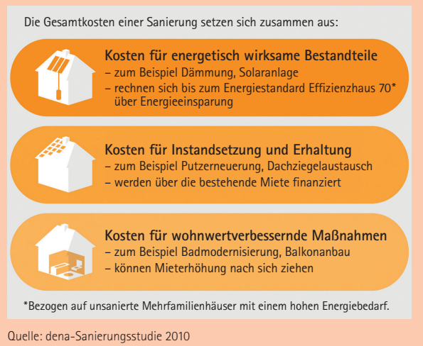
Abbildung 2: Sanierungskosten im Überblick
