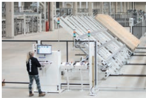
Serielle Fertigung eines Holzmoduls in einer NOKERA-Fabrik.
